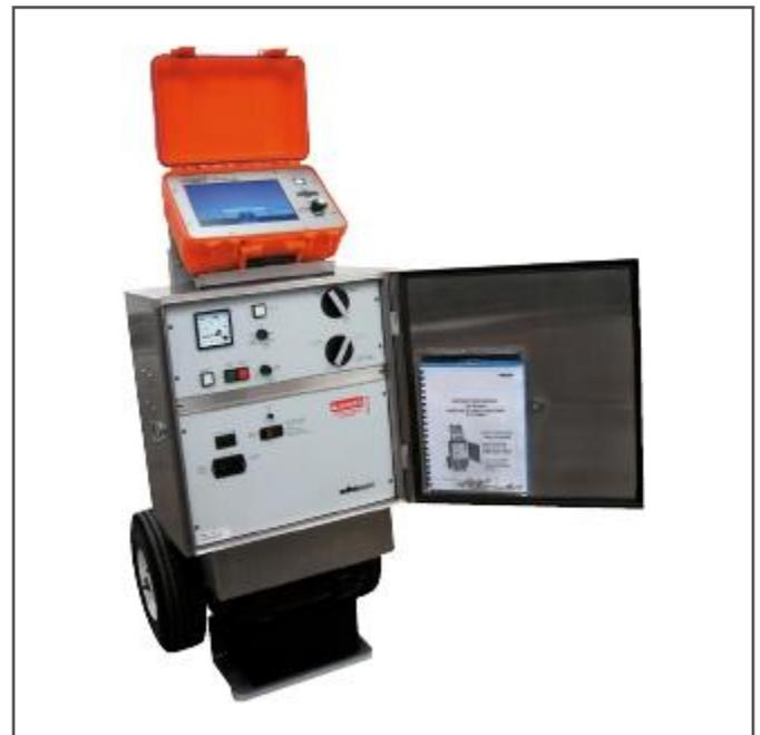
Mit bis zu 1150 J liefert das System im Stoßbetrieb ausreichend hohe Energieimpulse zum sicheren Nachorten der Kabelfehler nach der akustischen Methode. Das System besitzt feldtaugliche Transporträder und ist regenwassergeschützt.
