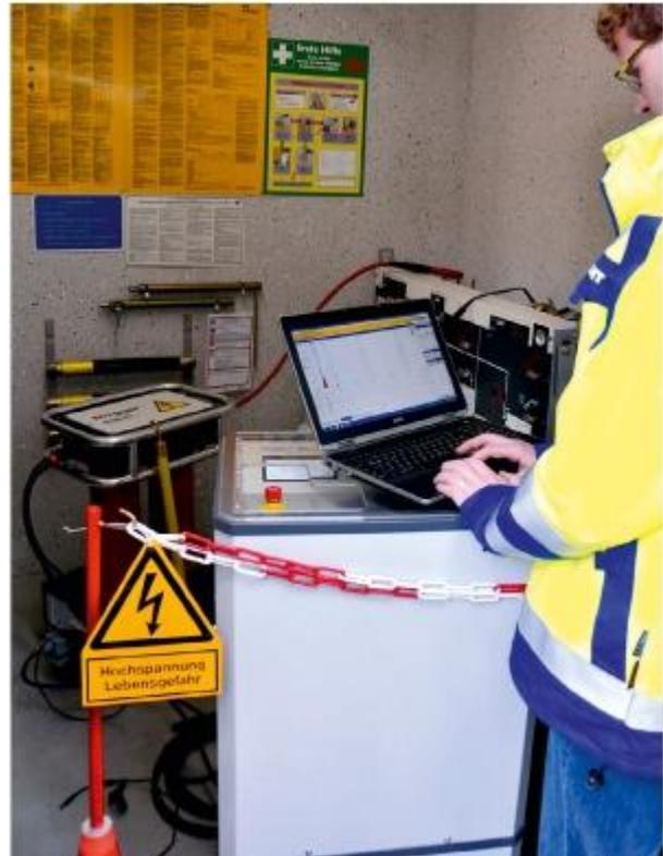
*TDS NT 40 und TE-Detektor PDS 60 in Kombination zur Überprüfung der Verlege- und Montagequalität*
